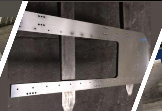
Placa para montaje de dispositivos. (Tolerancias de posición y planicidad de 0.05mm)
